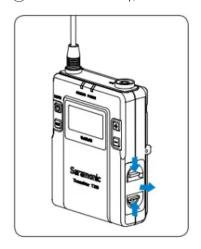
長按電源鍵關機。 向內按壓兩個鎖扣,拉出電池倉。 根據極性標記裝入兩節 AA 電池並關閉倉。 請確保電池倉已安全鎖定。
