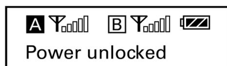
設置電源鎖。長按“-”進入功能表選項，短按“+/-”選擇鎖定或解鎖電源鍵，然後短按電源鍵確認。設置“Locked（鎖定）”鎖定電源鍵以防接收機在使用期間被無意關閉。
