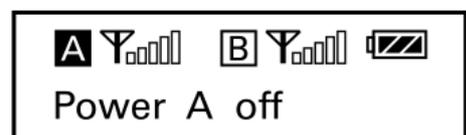
通道組狀態。僅使用一組通道時，請關閉其他組通道以節省電量。系統預設A組通道打開，B組通道關閉。
