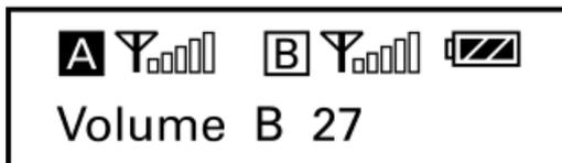
設置輸出音量：輸入音量設置範圍0-30。電源關閉後設置音量保存。系統預設27。
