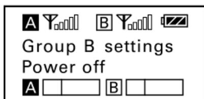
通道開啟：僅使用一組通道時，請關閉其他組通道以節省電量。系統預設A組通道打開，B組通道關閉。
