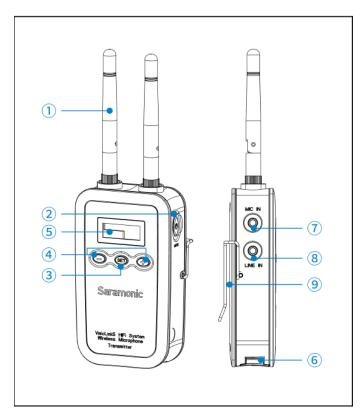
①天線: 沿順時針方向旋轉安裝天線, 逆時針方向旋轉拆除天線。
