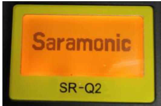
開機後，預設進入錄音介面，如果長時間不使用，導致時鐘備用電池電量耗盡，則開機後進入時鐘設置畫面。
