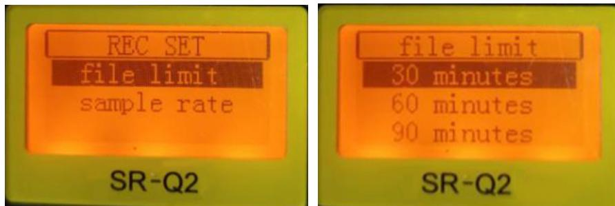
“sample rate”選項，設置錄音使用的取樣頻率，選項有6種：44.1kHz/16bit、44.1kHz/24bit、48kHz/16bit、48kHz/24bit、88.2kHz/16bit、96kHz/16bit。
